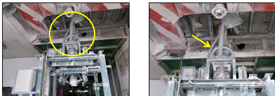
ภาพที่ 2.11 ท่อลมดูดฝุ่นขณะจ่ายปูนซีเมนต์ใส่รถเต๋า
