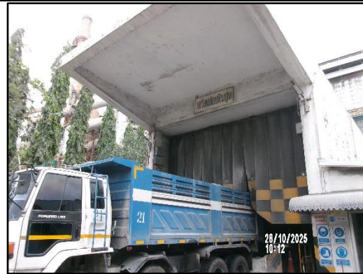
ภาพที่ 2.40 อ่างรับวัตถุดิบที่มีม่านยางป้องกันการฟุ้งกระจายของฝุ่นละออง
