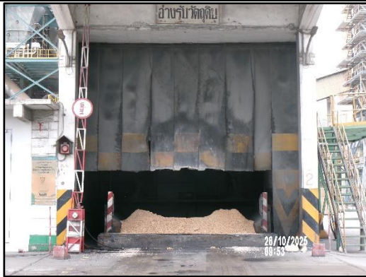
ภาพที่ 2.40 อ่างรับวัตถุดิบที่มีม่านยางป้องกันการฟุ้งกระจายของฝุ่นละออง
